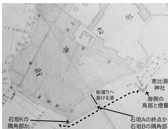
⑪若築建設所蔵 明治23年頃 若松港中洲之図(部分) →上記の「明治時代の若松市図」に描かれた状態に近いと推定される築港前の若松港を描いたもの →破線のラインが旧海岸線(護岸石垣)に相当する
